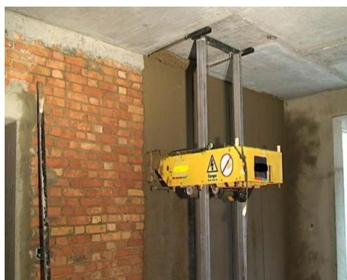
**Figura 3: Máquina rebocadora de parede. (<http://goo.gl/t8Z6eA>)**
