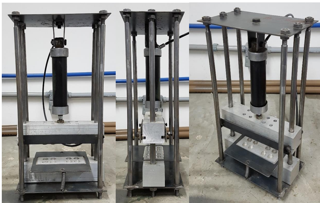
Figura 5. Blister Machine montada, vistas frontal, de perfil e isométrica
