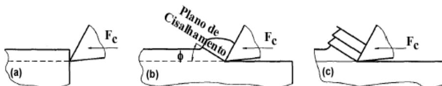
Figura 3.3 – Modelo proposto por Timme para a formação do cavaco (1880 apud ASTAKHOV et al. 1997).
