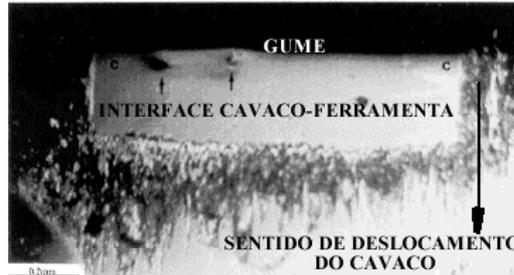
Figura 3.2 – Vista da interface cavaco-ferramenta através de uma ferramenta de vidro de cal de soda na usinagem do chumbo (Adaptado de MADHAVAN et al. 2002)
