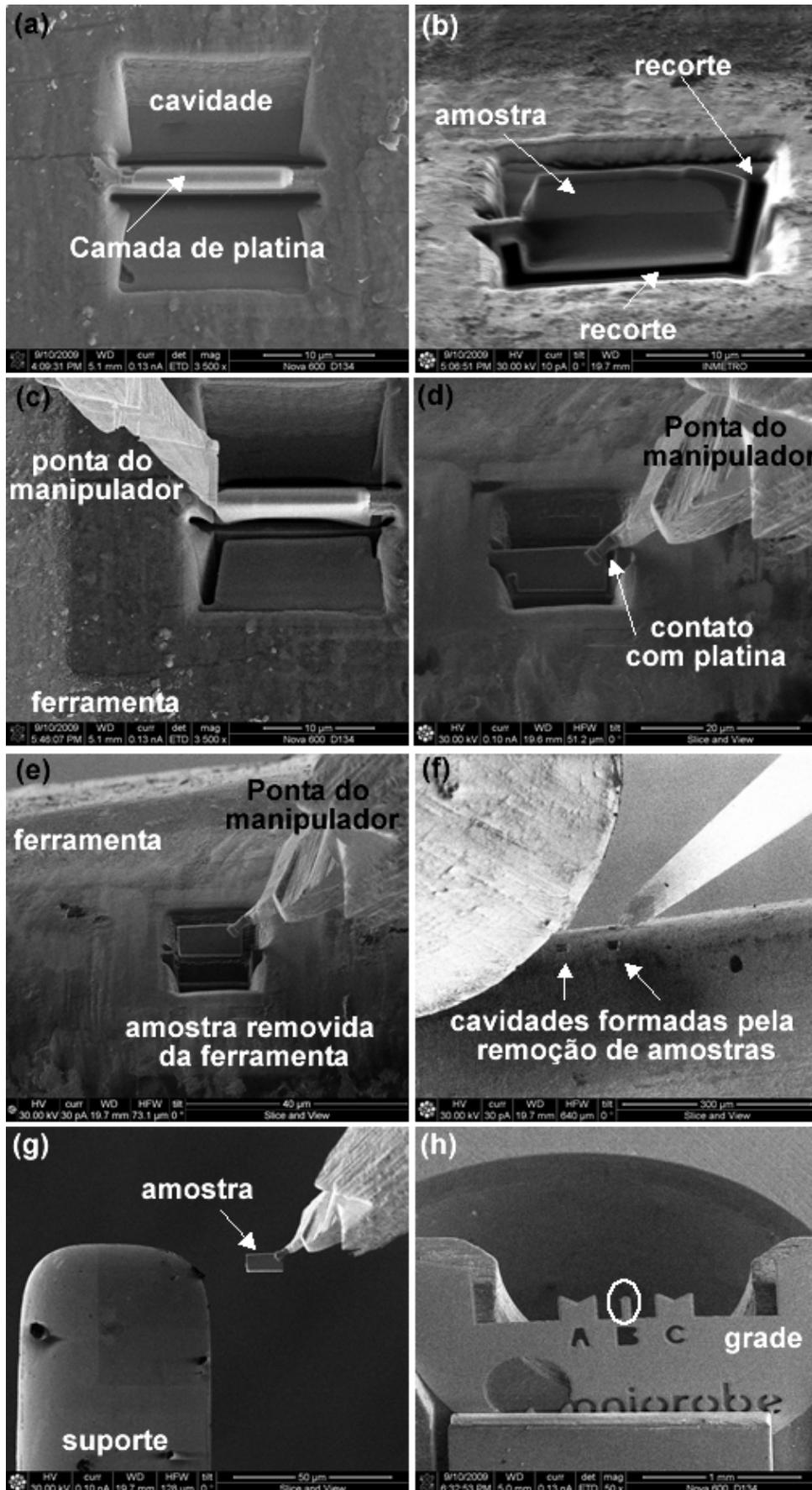
Figura 4.10 – Etapas do processo de preparação da amostra de TEM por FIB.
