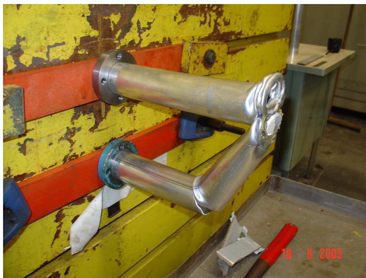
Figura 8.7 Espécimes B_{01\_03} e B_{01\_04} após impacto
