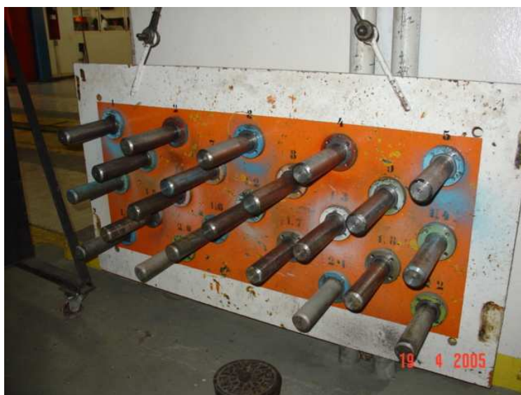
Figura 7.10 Condição de contorno do ensaio de trenó
