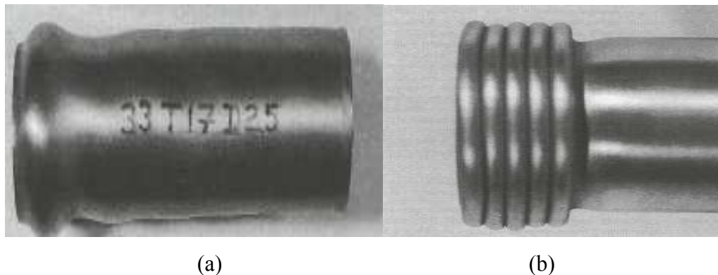
Figura 2.1. Cascas cilíndricas sujeitas a diferentes velocidades de impacto (a) Alta velocidade, flambagem dinâmica plástica (b) Baixa velocidade, flambagem progressiva [3]
