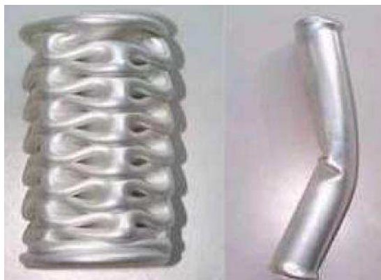
Figura 2.2 Flambagem progressiva (a) e global (b)
