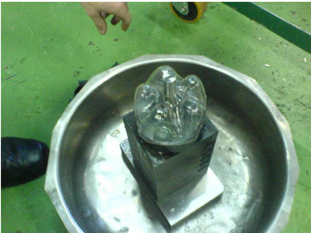
Figura A. 10 – Colocação da vedação e do pino acionador e proteção.
