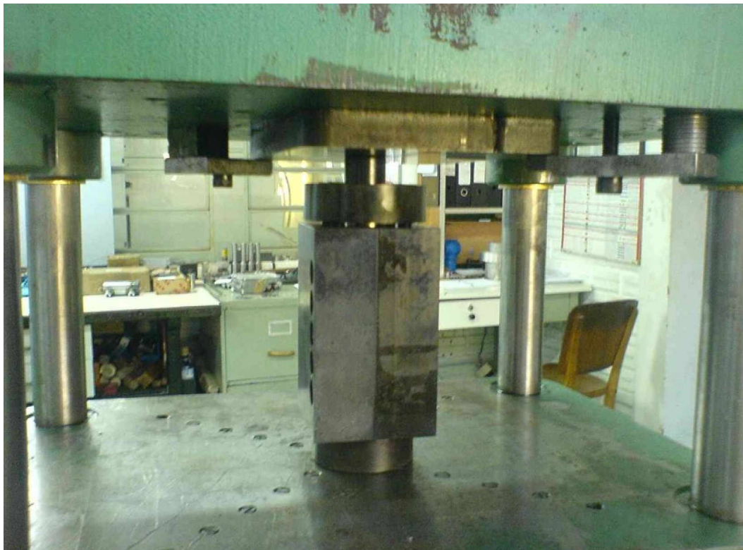
Figura A. 4 – Fechamento dos punções de vedação na prensa hidráulica.
