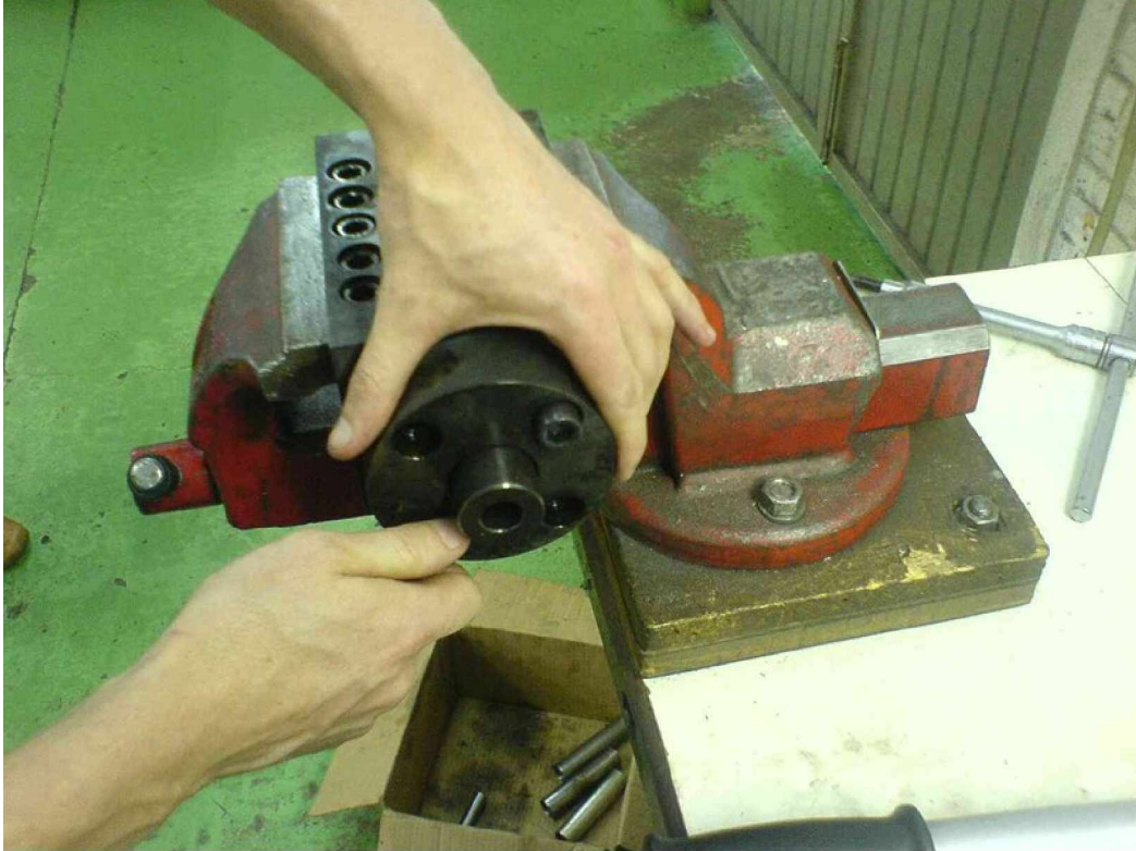
Figura A. 7 – Colocação dos parafusos na tampa do punção de vedação superior.
