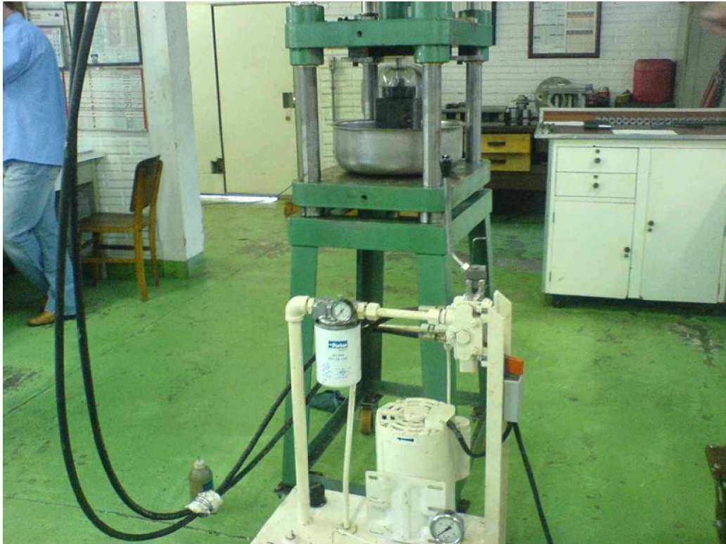
Figura A. 11 – Sistema colocado e preparado para hidroconformação na prensa.
