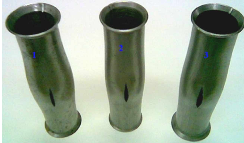
Figura 4.3 – Resultados dos testes nos tubos de aço SAE 1008 (1, 2 e 3) com expansão livre.
