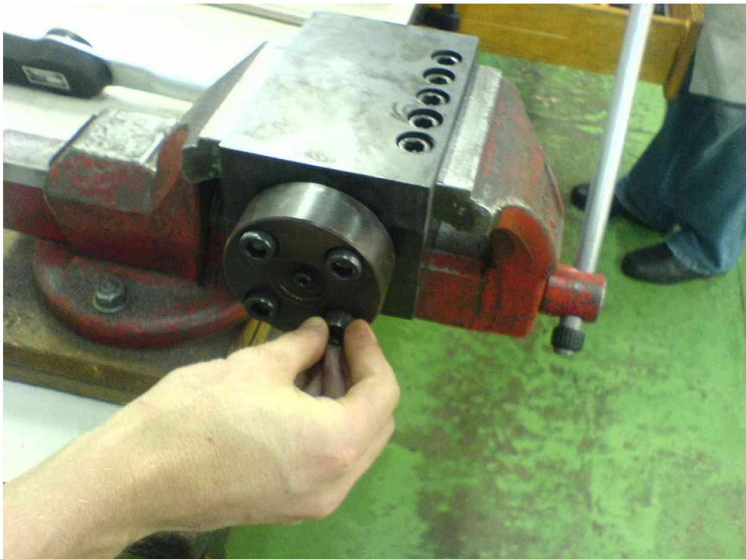
Figura A. 6 – Colocação dos parafusos na tampa do punção de vedação inferior.
