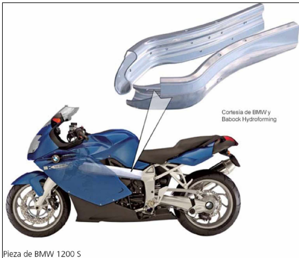
Figura 2.34 – Exemplo de uma peça estrutural e sua aplicação simulada - AUTOFORM [9].
