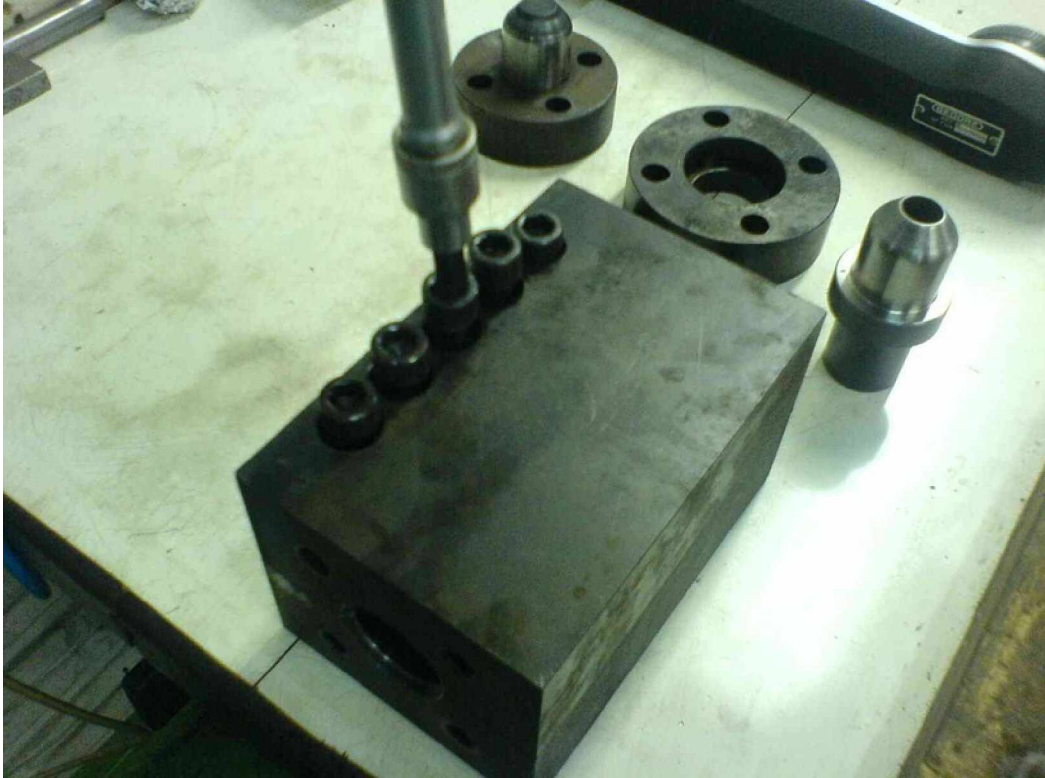
Figura A. 1 – Fechamento das matrizes por meio de parafusos.
