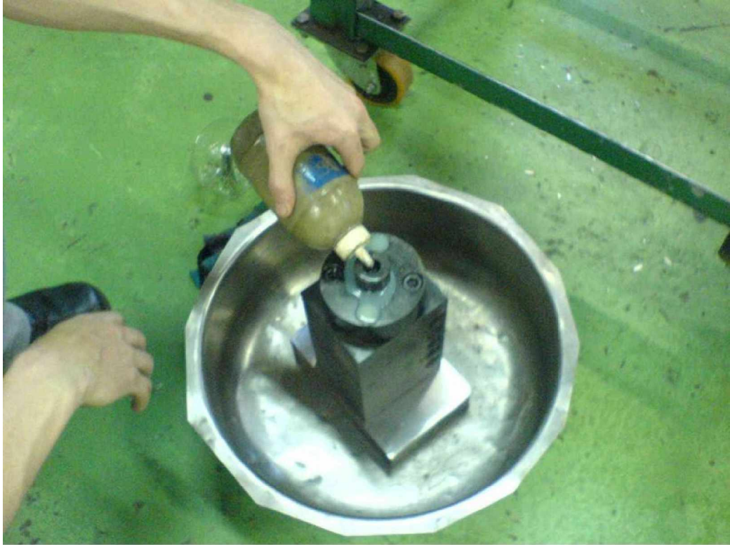
Figura A. 9 – Colocação do fluido água com óleo refrigerante.
