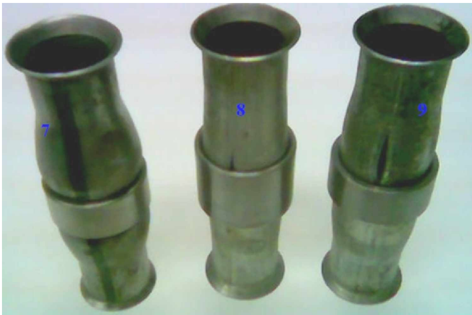
Figura 4.5 – Resultados dos testes nos tubos de aço SAE 1008 (7, 8 e 9) com anéis contínuos.
