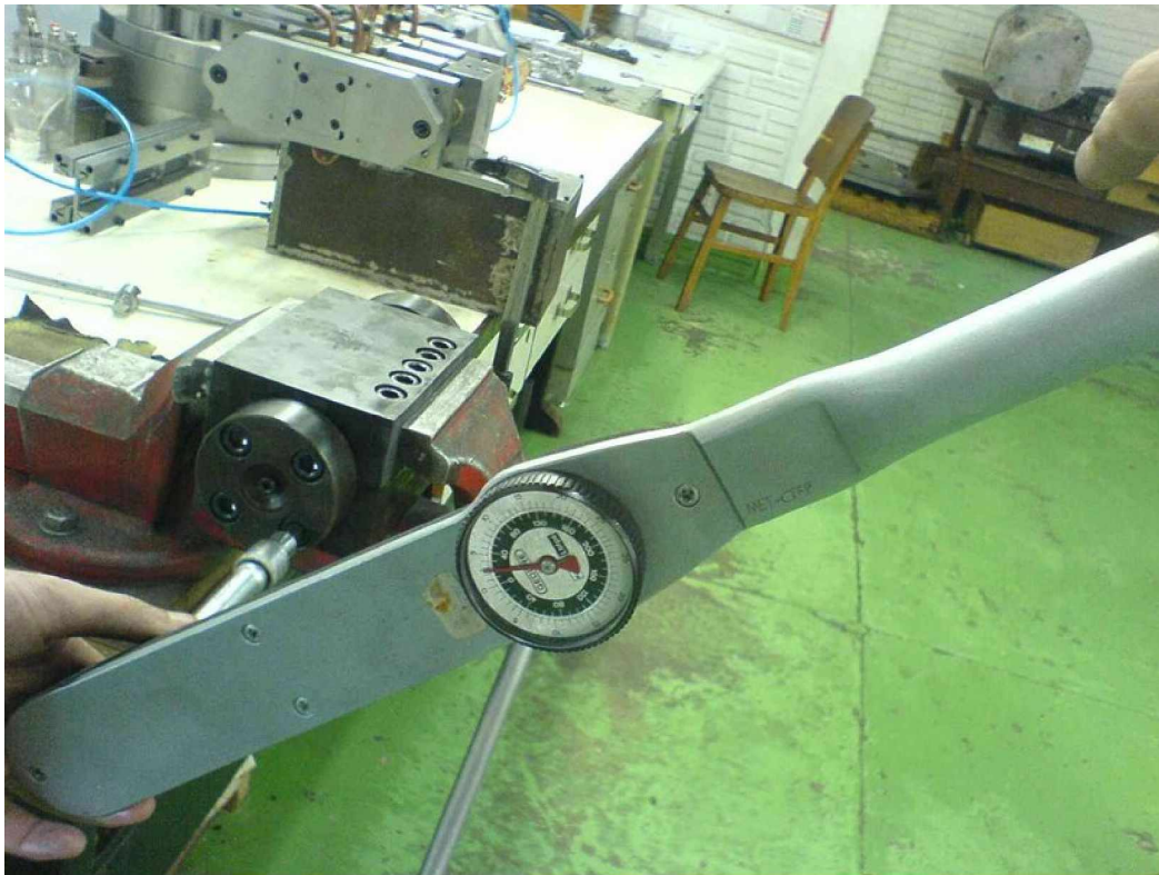
Figura A. 8 – Aperto dos parafusos das tampas dos punções de vedação com torquímetro.
