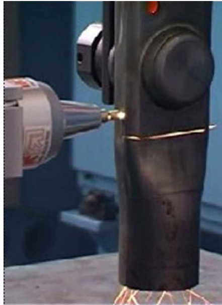
Figura 2.41 – Corte da ponteira de vedação feito por Laser - AMERICAN HYDROFORMERS [11].
