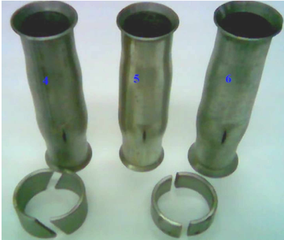
Figura 4.4 – Resultados dos testes nos tubos de aço SAE 1008 (4, 5 e 6) com anéis cortados.
