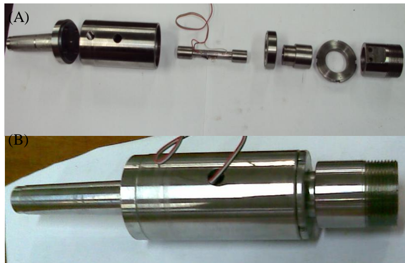
Figura 3-7 Transdutor de torque após sua conclusão: A) Componentes do transdutor; B) Transdutor montado.
