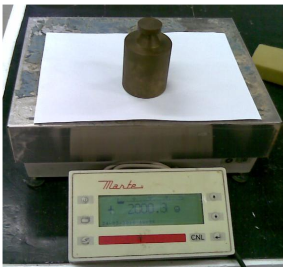
Figura 3-12 Verificação das massas padrões na balança de precisão
