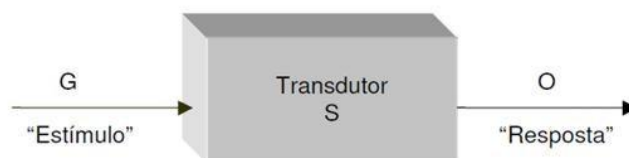
Figura 2-10 Representação esquemática de um transdutor Fonte: Borchardt (1999)
