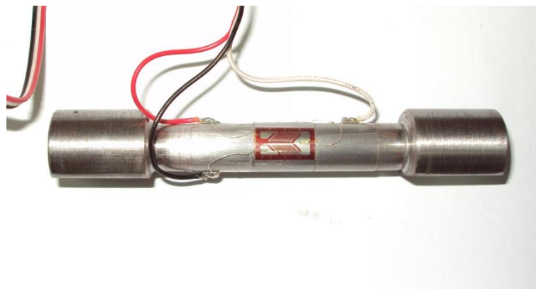
Figura 3-9 Eixo de torção com os extensômetros, terminais e cabos fixados
