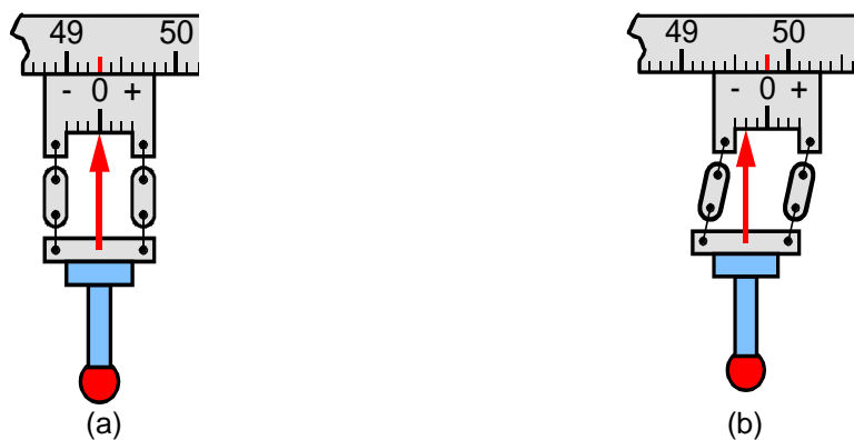
Figura 1.8 – Princípio de funcionamento dos apalpadores medidores no modo de medição ponto a ponto (a) e modo scanning (b) (adaptado de [9])
