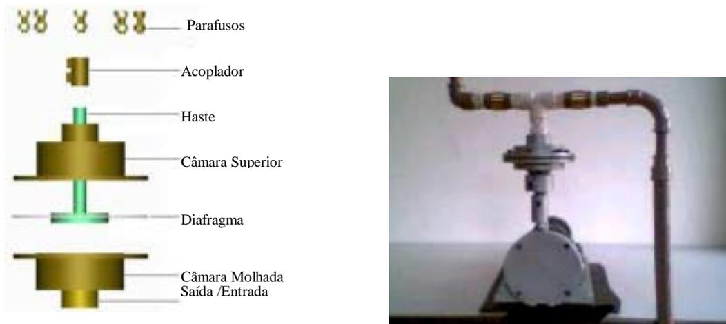
Figura 3. a) Detalhes de uma bomba de diafragma. b) Vista frontal com tubulação e válvulas.
