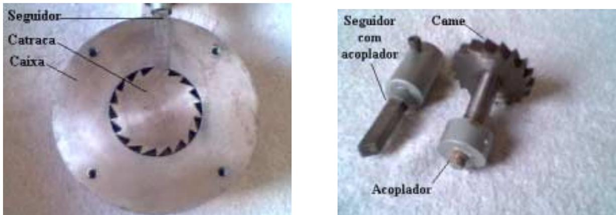
Figura 2. a) Came na caixa, fabricada em aço. b) Conjunto came e seguidor com os seus acopladores.
