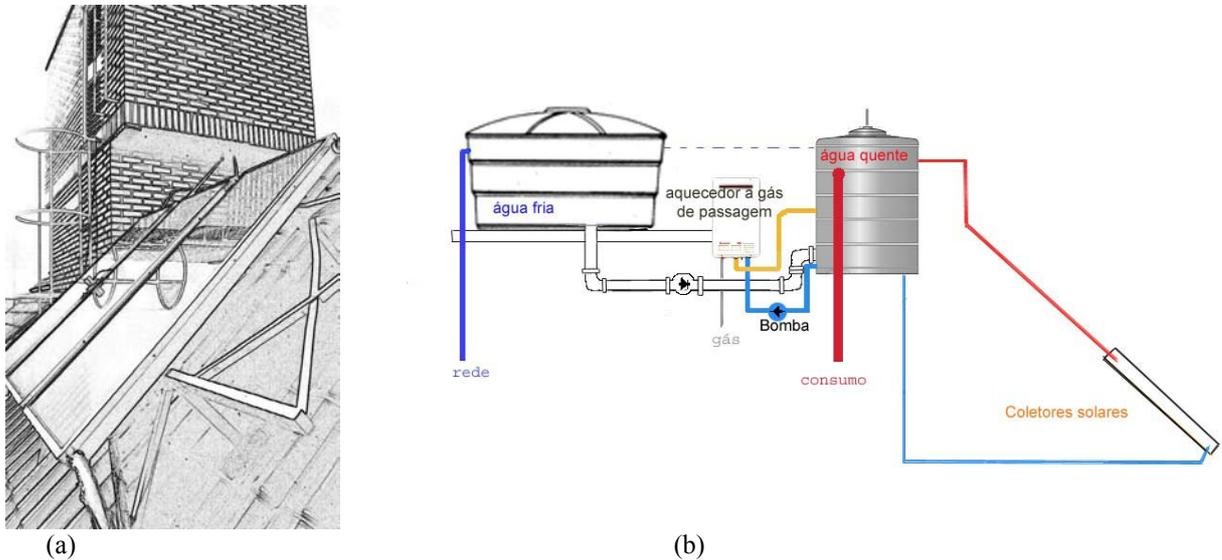
Figura 2 (a) disposição dos coletores solares no telhado e torre da caixa d'água (b) esquema de ligações hidráulicas.
