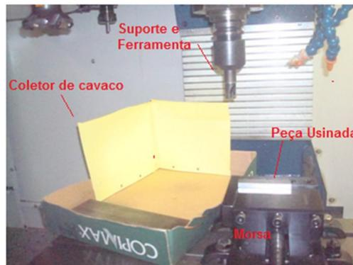
Figura 3 – Fixação do corpo de prova e coletor de cavaco.
