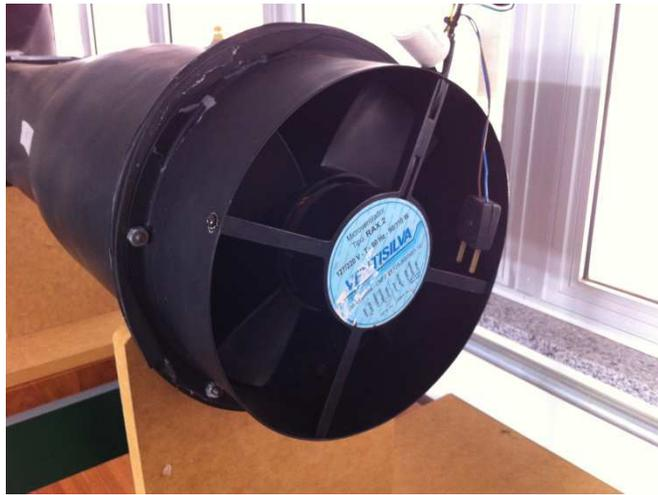
Figura 3 – Ventilador utilizado no túnel de vento.
