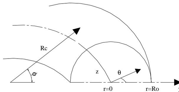
Figura 1: Relação entre a curvatura do duto e seu respectivo diâmetro
