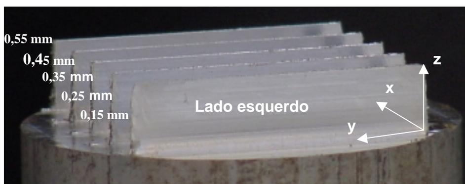
Figura 1 – Disposição das aletas no corpo de prova em relação aos eixos de referência.
