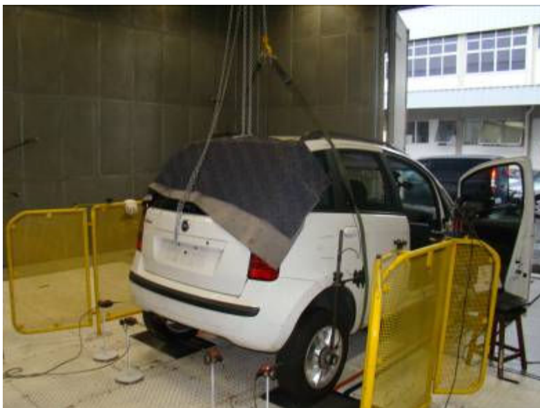
Figura 3. Veículo posicionado para provas de fracionamento de Coast Down do eixo posterior.
