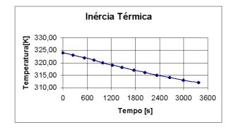
Figura 9 – Inércia térmica da Cuba Rotativa em R=0,23m e H=0,06m
