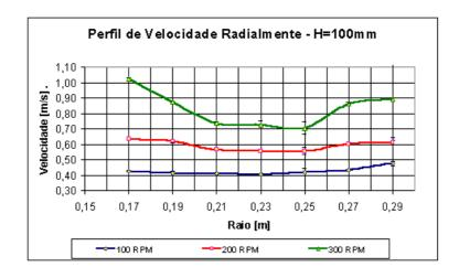
Figura 8 – Perfil de velocidade na veia líquida da cuba – H=100mm
