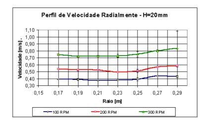
Figura 6 – Perfil de velocidade na veia líquida da cuba – H=20mm
