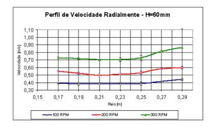
Figura 7 – Perfil de velocidade na veia líquida da cuba – H=60mm
