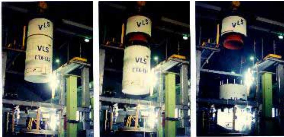
Figura 12. Ensaio em Solo de Separação do 2º Estágio do VLS.
