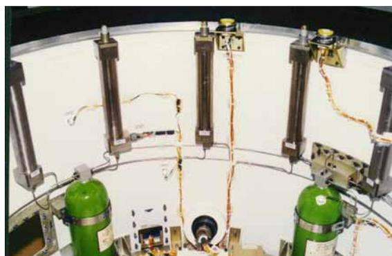
Figura 5. Sistema de Separação do 2º Estágio montado no VLS
