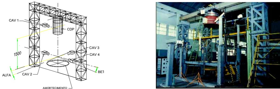
Figura 10. Pórtico para Ensaio de Separação em Tandem.
