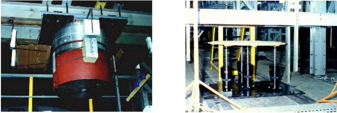
Figura 11. Corpo de Prova (CDP) e mesa de amortecimento.
