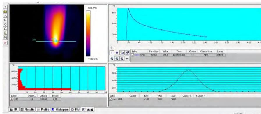
Figure 10-Graphical Interface Software 2.9 Thermocam research, Approach A (EN=50%  $I_m^+=165\text{A}$ ;  $I_p=250\text{A}$ ;  $I_{b1}=I_{b2}=40\text{ A}$ ;  $t_p=5,9\text{ms}$ ;  $t_{b1}=2,73\text{ms}$ ;  $t_{b2}=1\text{ms}$ ;  $F_s=4,8\text{m/min}$ ;  $t_n=9,6\text{ms}$ ;  $T=19,3\text{ms}$ ;  $t_n=9,6\text{ms}$ ;  $t_2 = 689,7^{\circ}\text{C}$ ;  $t_{time}=20\text{s}$ )
