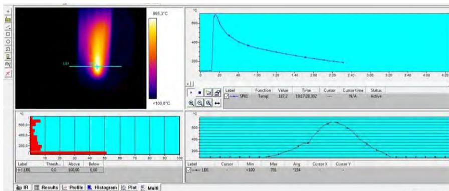
Figure 10 - Graphical Interface Software 2.9 Thermocam research, approach B (EN = 50%  $I_m^+=165\text{A}$ ;  $I_p=250\text{A}$ ;  $I_{b1}=I_{b2}=40\text{ A}$ ;  $t_p=5,9\text{ms}$ ;  $t_{b1}=2,60\text{ms}$ ;  $t_{b2}=1\text{ms}$ ;  $F_s=5,2\text{m/min}$ ;  $t_n=9,50\text{ms}$ ;  $T=19$ ;  $t_n= 9,508\text{ms}$ ;  $t_2 = 689, 7^{\circ}\text{C}$ ;  $t_{time}=20\text{s}$ )
