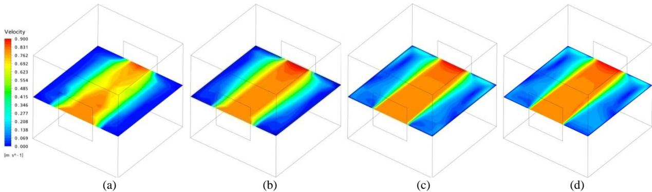
Figure 5 - Velocity contours for internal domain mesh spacing (a) 0,60 m; (b) 0,40 m; (c) 0,10 m; (d) 0,08m.
