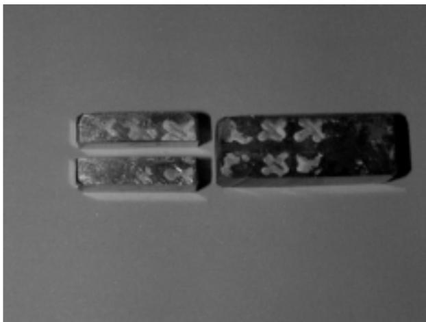
Figura 6 - Corte da amostra retirada da ponta do desponte forjado
