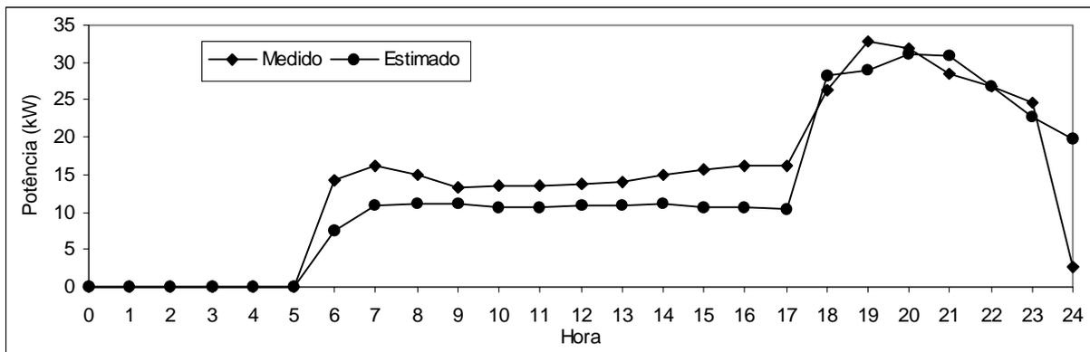
Figura 2: Perfil da curva de carga estimada e do Sistema de Vila Campinas (agosto/1997).
