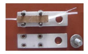
Fig. 1.b. The sandwich clamp.
