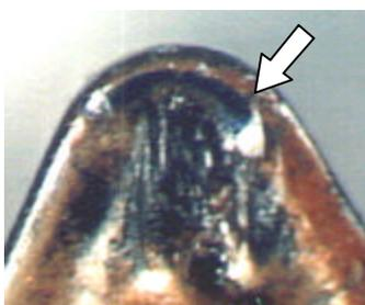
Figura 6 –Desgaste de cratera em ferramenta de acabamento com 140 peças usinadas.
